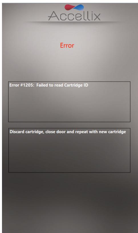
Figura 50: Ejemplo de un mensaje de error
